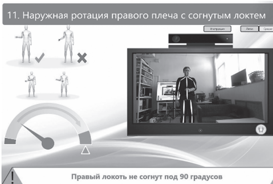
Рис. 1. Фрагмент работы с программно-аппаратным комплексом «Хабилект» — выполнение физического упражнения, нацеленного на восстановление функции правой верхней конечности
